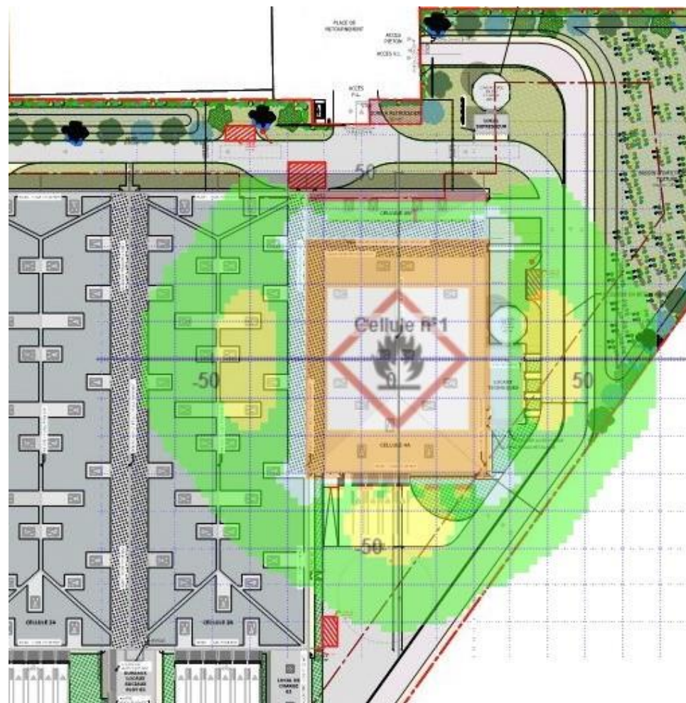
Incendie d'une cellule de stockage de liquides inflammables Palette LI
